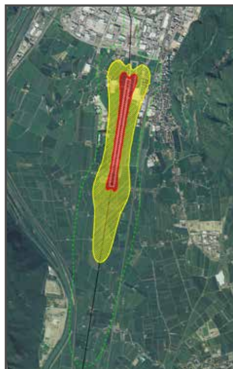
2015 PASQUALI RAUSA Studie 2016 für ABD – Ergänzung Umweltscreening: Plan 5, Linien gleichen Schallspiegels gemessen mit LVA-Index, Base case – theoretischer Spitzentag: 60 dB (grün), 65 dB (gelb), 75 dB (rot). Januar 2016.
